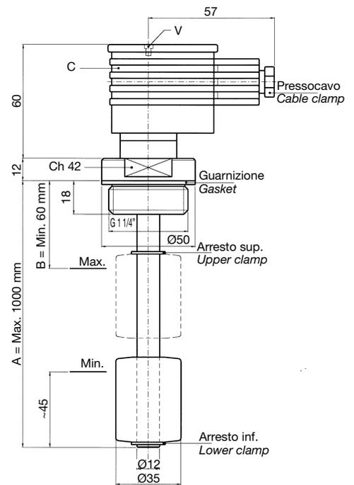
Le sonde di livello SL1M3FA..., SL2M3FA... e SL1M3TA..., SL2M3TA... sono state concepite per controllare il livello di un liquido contenuto in un serbatoio e inviare a distanza tre segnali di allarme regolabili a piacere.
