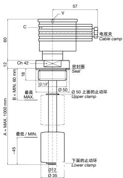
液位传感器SL1MFA ... CVS1和SL2MFA ... CVS1,SL1MTA ... CVS1和SL2MTA ... CVS1配备有4/20 mA信号转换器装在C接头中,旨在连续检查罐中液体的液位。
