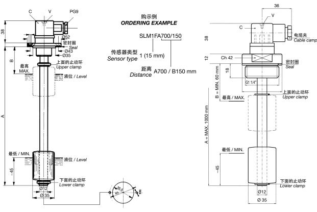
液位传感器SL1MFA...和SL2MFA...、SL1MTA...和SL2MTA...被设计成可以通过我们的数字指示器在一定距离处连续地检查罐中液体的液位。
