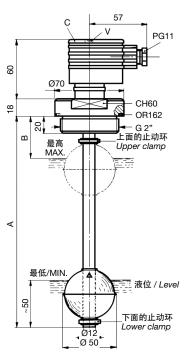
液位传感器SL1FIA...CVS1和SL2FIA...CVS1, SL1TIA...CVS1和 SL2TIA...CVS1配备有4/20 mA信号转换器装在C接头中,旨在连续 检查罐中液体的液位。
