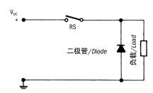
图1 Fig. 1 直流电感应性负载用半导体二极管进行保护
