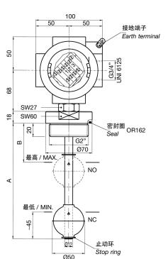
研究、设计这些型号的电磁式浮子液位指示器是用来监控在容器里的油、水、溶剂的液位。当容器里的液体高于或者低于设定的液位时,电磁式浮子液位指示器都应该 示器就会发送电气信号到远程控制面板上。这些电磁式浮子液位指示器都应该 垂直地安装在容器的盖子上,而其浮子离金属内壁至少要保持50毫米的距离。
