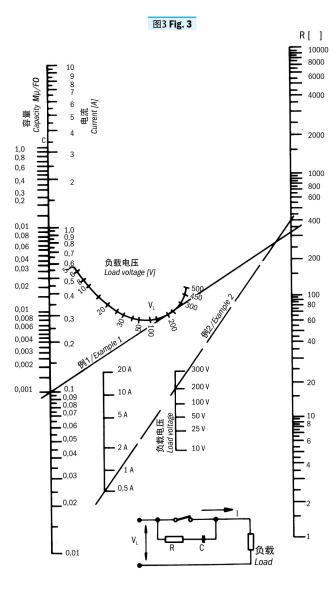
RC连接消弧器 Arc suppressor with RC link
