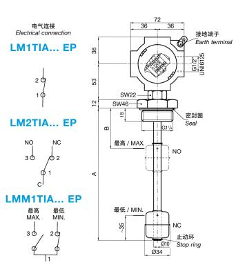
研究、设计这些型号的电磁式浮子液位指示器是用来监控在容器里的油、水、溶剂的液位。当容器里的液体高于或者低于设定的液位时,电磁式浮子液位指示器都成会发送电气信号到远程控制面板上。这些电磁式浮子液位指示器都底。垂直地安装在容器的盖子上,而其浮子离金属内壁至少要保持50毫米的距离。
